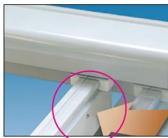
Grundsätzlich sind die mechanischen Teile wartungsarm. Gelegentliches Schmieren der beweglichen Teile (Kunststoffgleiter etc.) mit einem geeigneten Schmiermittel (Silikonspray) sowie periodische Kontrollen/Wartungen durch einen STOBAG Fachbetrieb wird empfohlen und kann die Lebensdauer des Glasdachsystems und der Beschattung verlängern.
