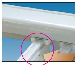
En principio, las piezas mecánicas no requieren ningún tipo de mantenimiento. Se recomienda lubricar ocasionalmente las piezas móviles (regletas de plástico etc.) con un lubricante adecuado (pulverizador de silicona), así como encargar a un establecimiento especializado STOBAG que realice revisiones y/o mantenimientos periódicos, ya que de este modo se puede prolongar la vida útil del sistema de techo de vidrio y del toldo.
