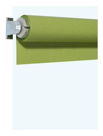
Robustes und wartungsfreies Federzugrollo, welches sich auch für die Aussenmontage eignet. Aluminiumrohr Ø40 mm und eingebaute Feder mit Arretierung. Das Rollo kann dadurch in jeder Auszugsposition anhalten. Wand-, Decken- und Nischenmontage möglich.
