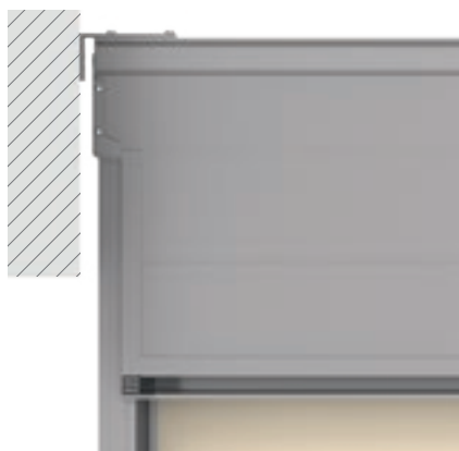
Befestigung seitlich an einer Wand oder in einer Nische mit dem Befestigungswinkel 200 x 100 x 10 x 140 mm
