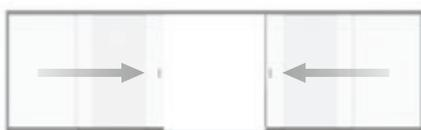
Stulpanlage – nach zwei Seiten zu öffnen, schließt in der Mitte
